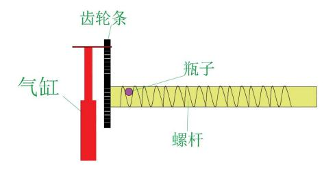
气缸: Cylinder 齿轮条: Gear bar 瓶子: Container 螺杆: Screw
